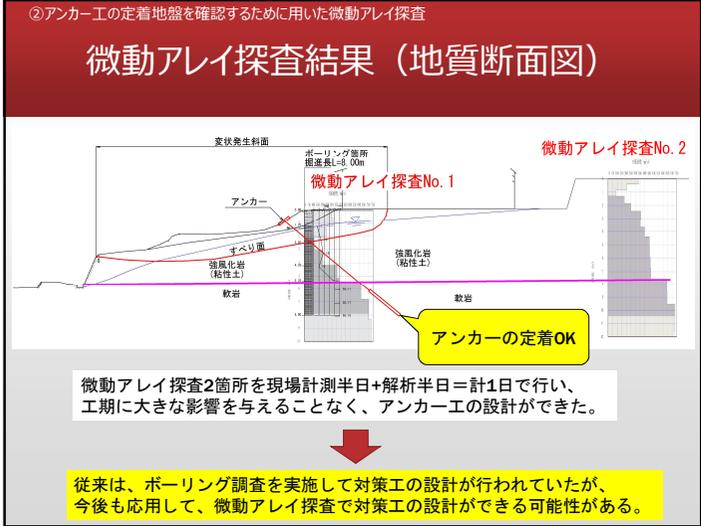
②アンカー工の定着地盤を確認するために用いた微動アレイ探査
