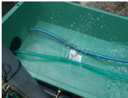
図-2 ソイルパイプを表現したホースから水が噴き出す仕組み
