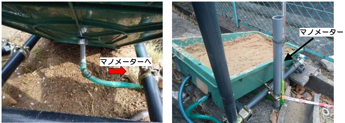
図-3 土槽の裏側から接続したマンノメーター
