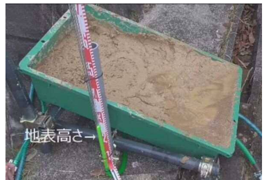
図-5 模型実験状況 (写真の矢印の位置が地表高さであり、染料を混入したマンノメーターの水位は、その地表高さより最高 4cm 程度上まで上昇した。)
